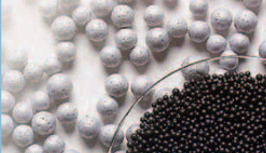
Neopor-Kügelchen werden in einem speziellen Verfahren bis auf das Fünzigfache ihres Ausgangsvolumens aufgeschäumt
